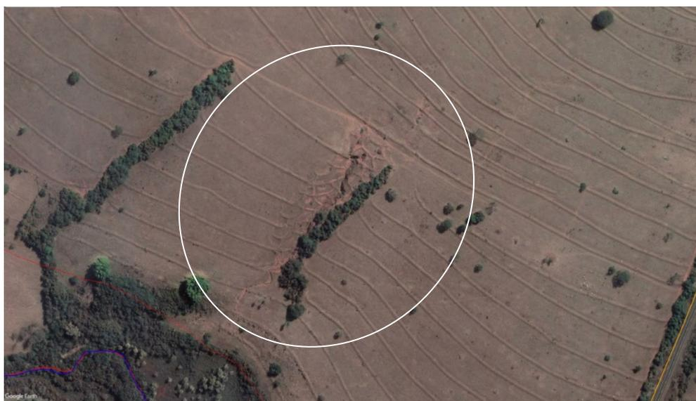
Figura 6.3.1-2 – Cicatrizes antigas de feições erosivas lineares, do tipo voçoroca, atualmente estabilizadas, localizadas na AID do empreendimento.
