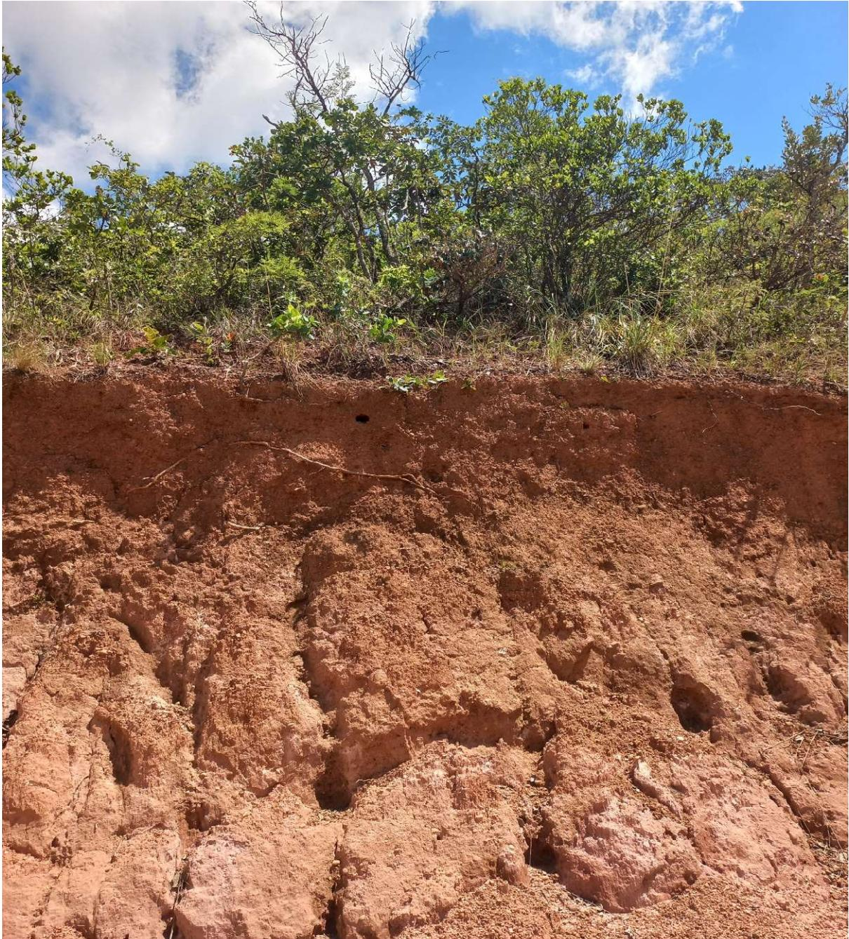
**Figura 13.28:** Latossolo Vermelho distrófico típico, textura média na sua variação LVd1 presente nas áreas de influência do empreendimento em condições de relevo plano a suave ondulado e boa drenagem da chapada da região. (Autor)
