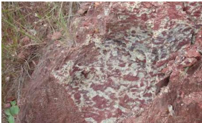
**Figura 13.25:** Arenito imaturo da Formação Marília exposto em um corte da BR-452 distante cerca de 5,7 quilômetros do trevo de acesso ao distrito de Tapuirama (sentido Nova Ponte). (Autor)
