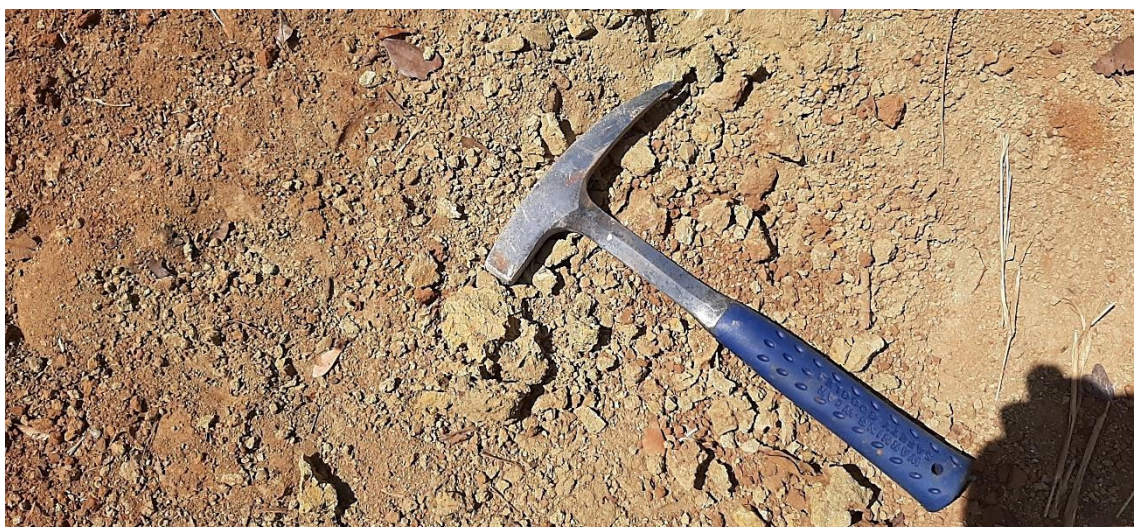
Figura 5.4.4-2 – Rocha vulcânica máfica da Formação Capacete totalmente intemperizada. Atentar para a coloração esverdeada desse material.
