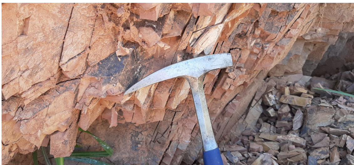
Figura 7.2-4 – Siltitos da Formação Serra da Saudade (grupo Bambuí) fotografado em local de exposição recente. Atentar para os planos de acamamento com elevado ângulo de mergulho.
