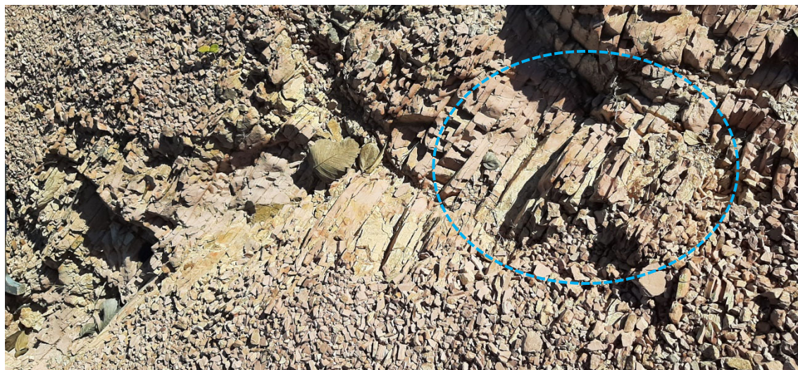
Figura 7.2-1 – Planos de acamamento em siltitos da Formação Serra da Saudade. Atentar para o ângulo de mergulho desta estrutura rochosa.
