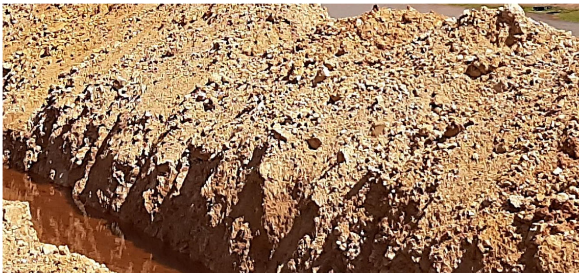
Figura 7.4-2 – Coloração amarelada e/ou ocre, indicativa de condição redutora e hidromórfica.
