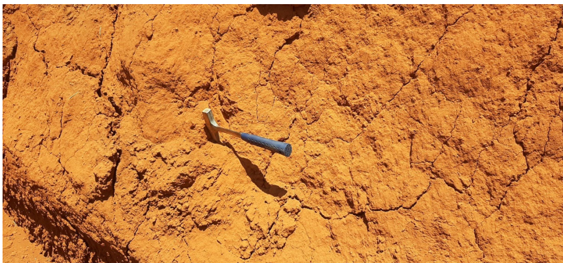
Figura 4.1.1-4 – Aspecto do perfil de um Latossolo Vermelho distrófico na ADA do empreendimento – Chapadão da Ponte Firme.
